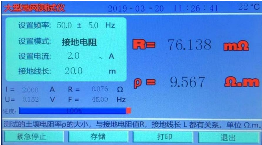
图 16 接地电阻测试结果界面
